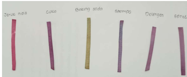
Gambar 3. Hasil uji kertas indikator pada larutan sampel
